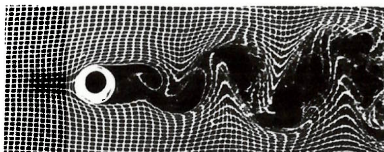
Figura 2.4 - Linhas de corrente e linhas de tempo feitas com bolhas de hidrogênio
